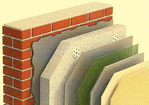
I materiali isolanti; Analisi dei supporti; L'incollaggio e la tassellatura; La rasatura armata; Le finiture; Gli accessori; Cenni di Manutenzione Posizionamento profili di partenza; Preparazione del collante; Incollaggio dei pannelli; I tasselli e gli accessori per l'isolamento termico a cappotto; Applicazione di rasatura armata; Primer e finitura.
